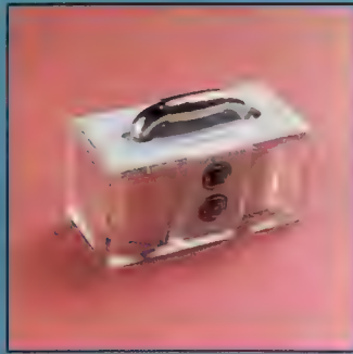
Electro-aimant La barre de métal située sur l'électro-aimant glisse à l'intérieur du dispositif de saisie du bras-robot. L'électro-aimant peut être mis en fonction et hors fonction, ce qui permet au robot de soulever les petites plaques métalliques fournies.
